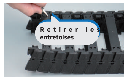
Insérer le tournevis dans la fente. Faire levier pour déconnecter l'entretoise
