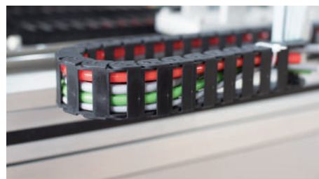
La chaîne couchée, un côté de la chaîne est supporté
