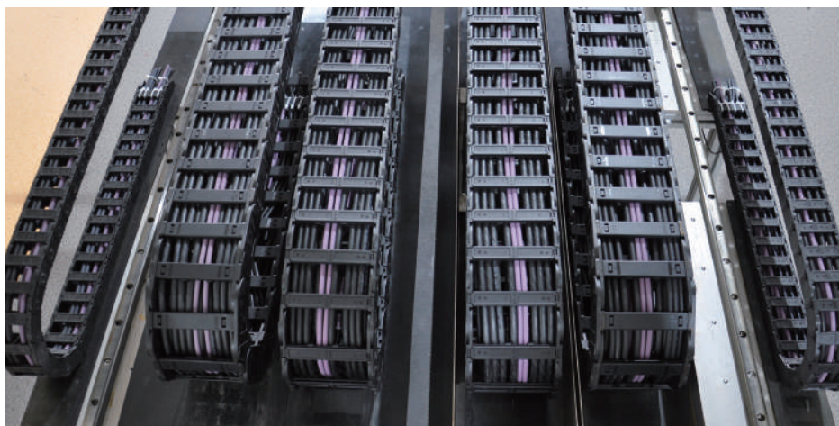
Test de durabilité sur des petites courses pour chaînes porte-câbles et câbles dynamiques
