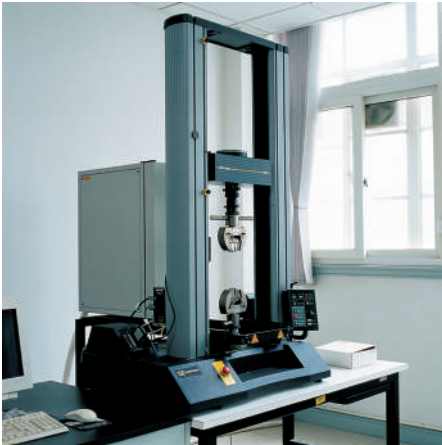
Tests matériaux sur Instron 5567
