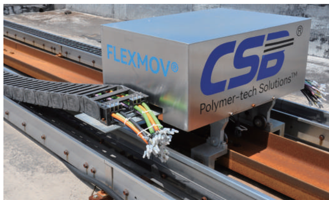
Test de durabilité en transfert extérieur sur des longues courses pour chaînes porte-câbles et câbles dynamiques
