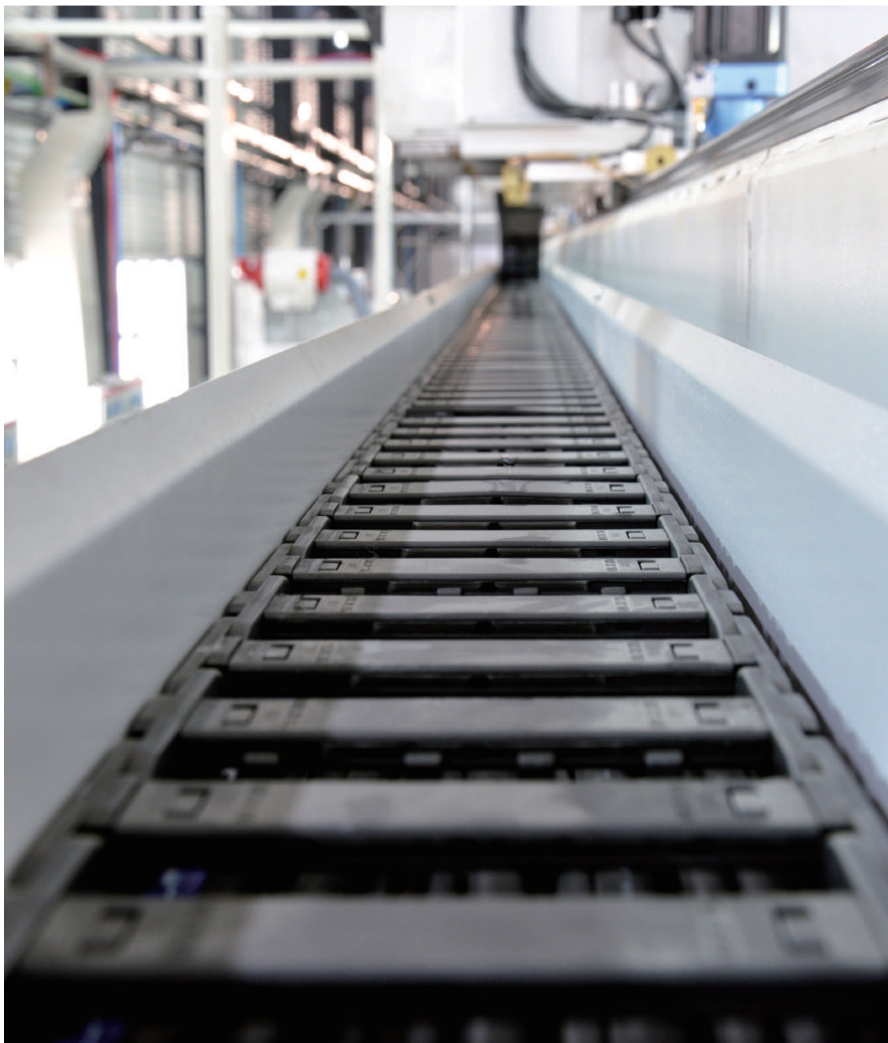
Les porte-câbles C03 protègent les câbles des robots à longue course
